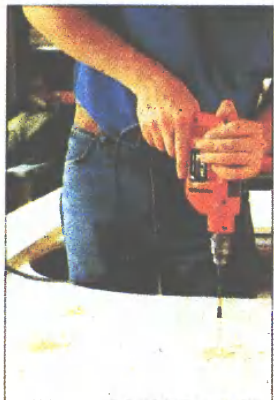
2. Прежде чем выпилить деталь, в углах сделаем отверстия сверлом по дереву.
