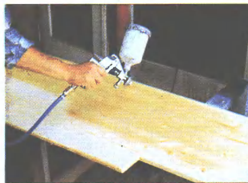
13. Быстро-сохнущий лак наносится пневматическим распылителем. Можно использовать электрический краско-распылитель.
